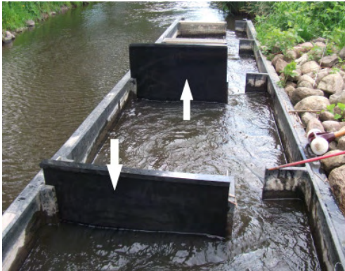
Abb. 2: Versuchsaufbau undurchlässige Stauwand [GÜTLING 2011]
