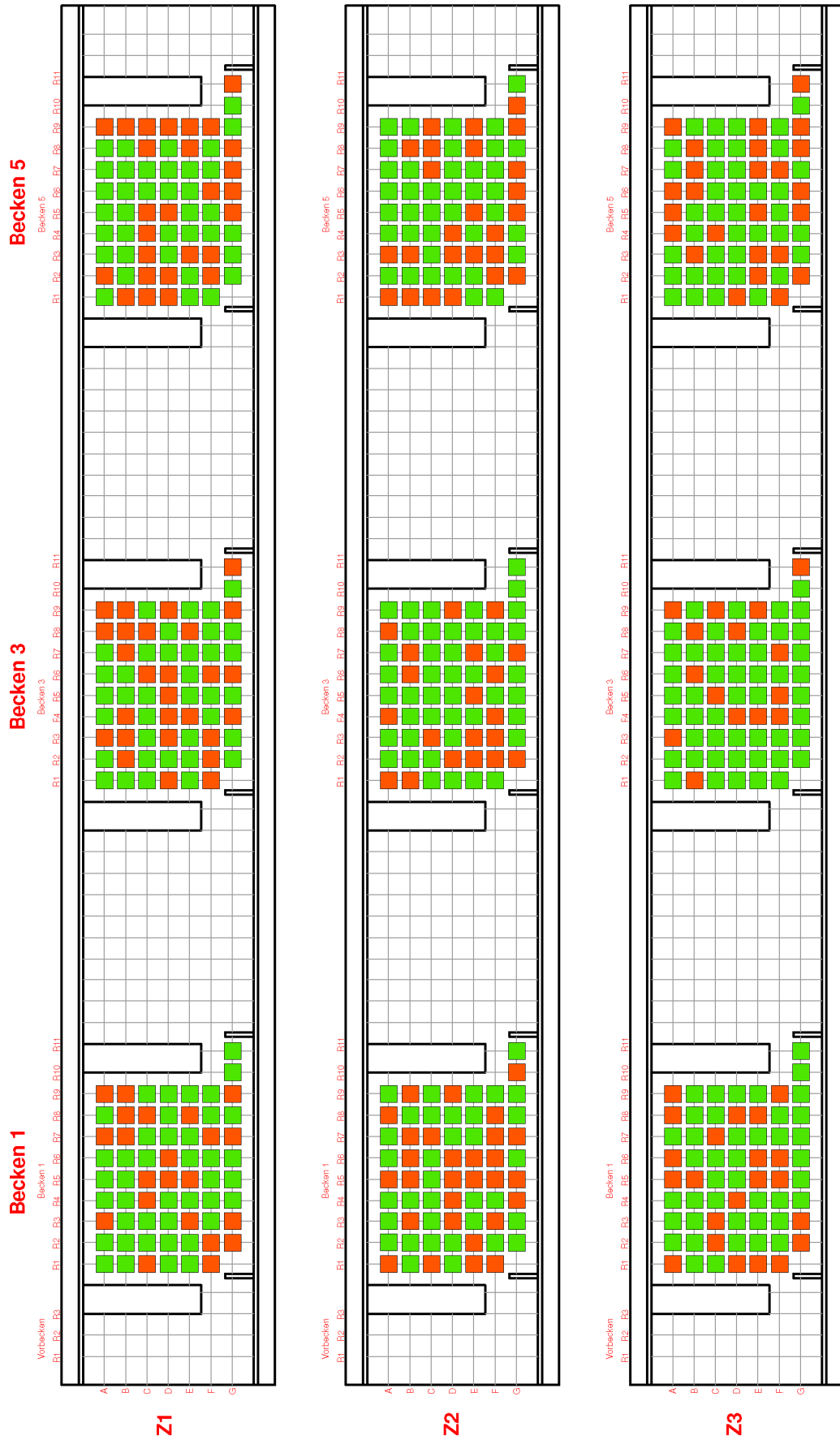
Abb. 4: Positive (grün) und negative (rot) Richtungsänderungen der Strömung beim aquaLEB-Pass im Vergleich zur undurchlässigen Wand
